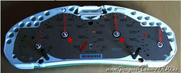
Bild 10: Nun die Folie über die Zeiger hebeln und nach oben abziehen. Bild 10
