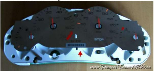
**Bild 11:** Die LEDs (in SMD-Bauform) sitzen an den markierten Stellen. Die LEDs haben eine kleine Kerbe an einer Ecke. Vor dem Auslöten solltet ihr euch aufzeichnen, an welcher Stelle diese Kerbe an dem Bauteil ist, damit ihr wisst, wie herum die neuen LEDs eingelötet werden müssen. Beim Löten müsst ihr sehr behutsam vorgehen, damit ihr den Kunststoff von dem Tachogehäuse nicht verkohlt. Bild 11
