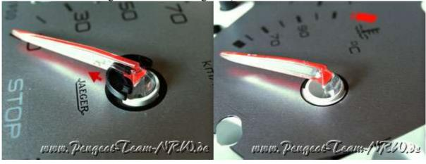
**Bild 9:** Als nächstes dreht ihr alle Zeiger auf "12 Uhr". Die Tachofolie vorsichtig an den markierten Stellen lösen, da sie hier eingerastet ist. Bild 9
