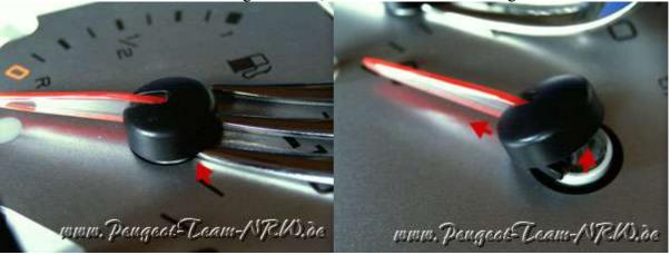
Bild 7: Anschließend schiebt ihr das Unterteil ebenfalls unter dem Zeiger raus.
