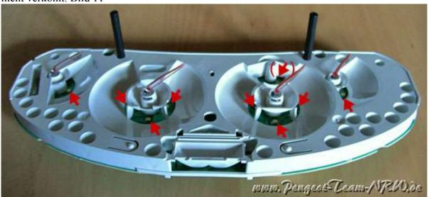
**Bild 12:** In meinem Fall habe ich weiße LEDs eingelötet und anschließend eine blaue Tönungsfolie unter die originale Tachofolie gelegt und diese an den farbigen Bereichen (DZM, Reserveanzeige, Wassertemp., 50,90 u. 130 km/h) ausgeschnitten. Die blauen LEDs lassen nämlich beispielsweise den "roten Bereich" im DZM violett leuchten. Bild 12
