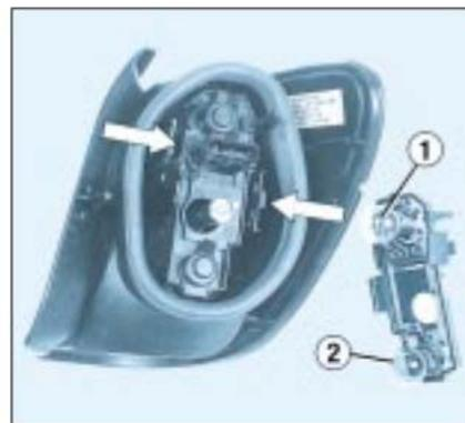
Um an die Glühlampen zu gelangen, auf die Sperrfedern drücken und den Lampenträger herausziehen.
