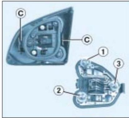
Lampenträger unter Druck auf die Sperrfedern **C** herausziehen.
